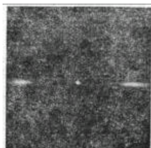
(b) 光栅式衍射图 ( H_V-90^\circ ) [\eta] = 4.9 (100 毫升/克) C = 12\% 水中凝固 STF = 46 毫米 \bar{P}_n = 1.9\mu
